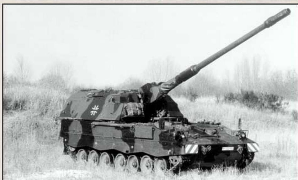
temul de incărcare automată include și modurile semiautomate sau manuale în caz de avarie, o magazie de muniție și o instalație de setare a focoaselor, de asemenea automate. Pentru navigație și poziționarea gurii de foc este utilizat un sistem GPS hibrid, iar calculatorul balistic de bord, conectat prin legătură radio la un punct de comandă (PCO), permite executarea misiunilor de foc cu rapiditate și indiferent de gradul de pregătire în poziția de tragere, după primirea coordonatelor țintei.
